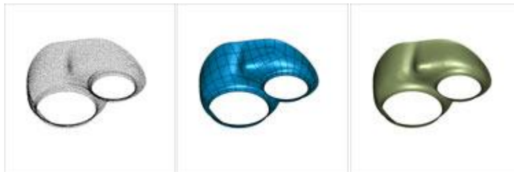
图片：Geomagic Design X 中燃烧室的点云、网格与曲面图
