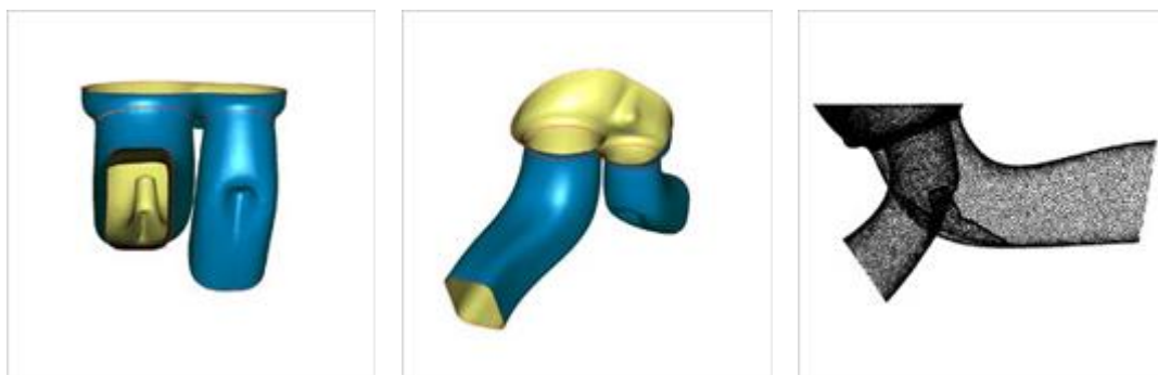
图片从左到右：Geomagic Design X 创建的内部的气缸盖细节；3D 点云版本的气缸盖口侧面图；在 Geomagic Design X 数字化重建的进气管、排气管与燃烧室总成数模。
